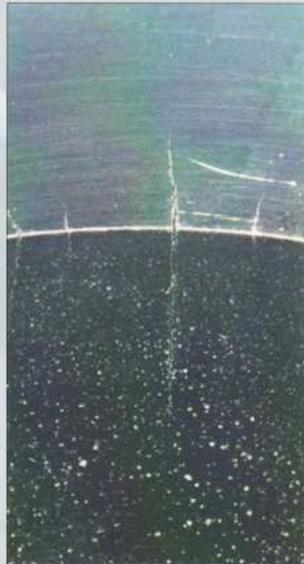
Deformazione dell'alloggiamento del cilindro. Rigatura o grippaggio pistone e fasce elastiche. Depositi carboniosi su esterno camicia del cilindro.
